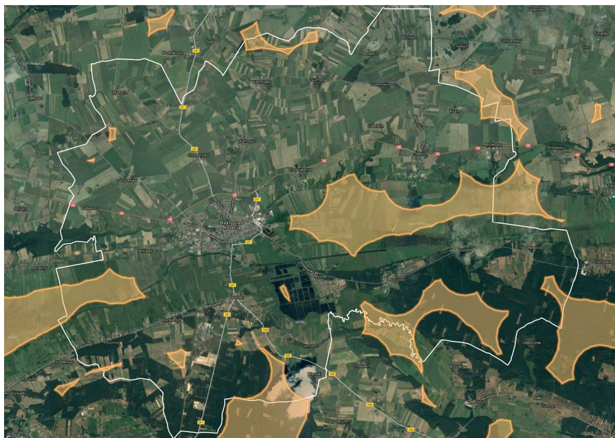
Ryc. 8. Obszar predysponowany do lokalizacji elektrowni wiatrowej na terenie Gminy Nakło nad Notecią (1 000 m od zabudowy mieszkalnej)
